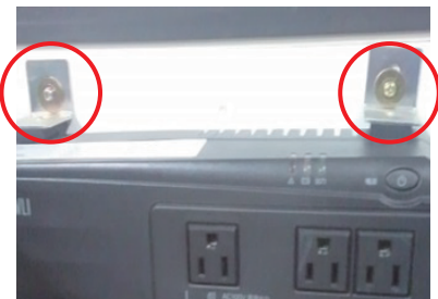
3. バッテリーボックス上部のネジ等を外してください。ネジ等は再び使用するため、紛失しないようご注意ください。
